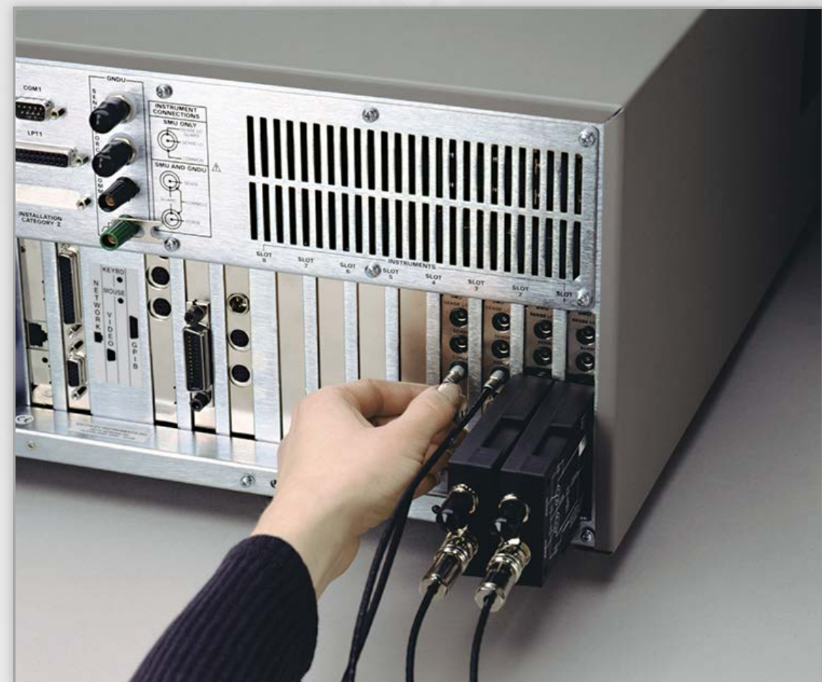
4200-SCS型のDCプリアンプは、パラメータ・アナライザの後部またはプローブ・ステーションに取り付けられます。DUTとプリアンプ間の信号パスを低減することで、4200-SCS型は寄生容量やリーク電流などの影響を抑えることができ、より正確な低電流測定が可能になります。
