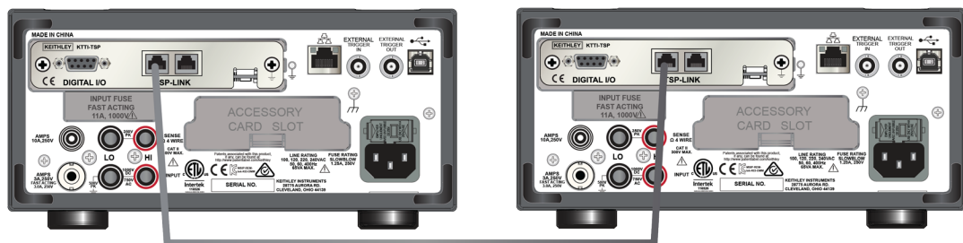
圖表 43：兩個與 TSP-Link 連接的 DMM
