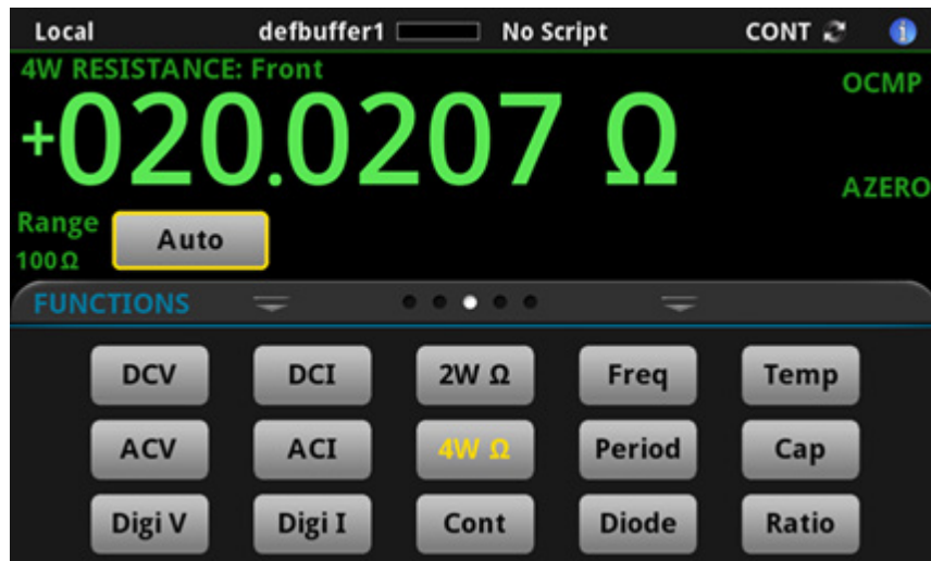
圖表 37：4 線電阻測試結果
