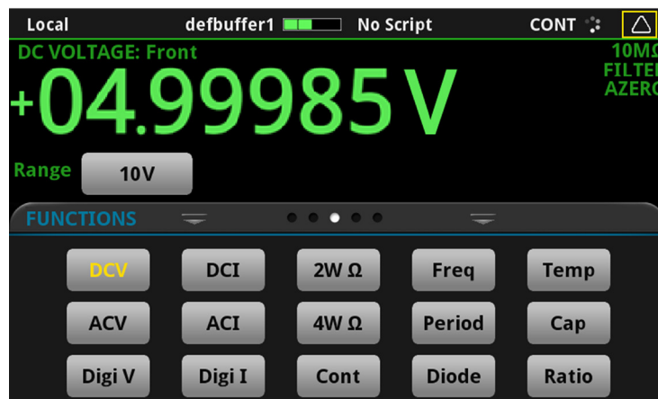
圖表 34：直流電壓高準確度測試結果
